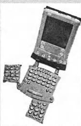
бильных компьютеров. Это необычное беспроводное устройство носит название FrogPad. Данное приспособление позволяет осуществлять набор текста одной рукой, после тренировок, конечно. Клавиатура содержит 20 клавиш, пять из которых — функциональные. Каждой кнопке соответствует четыре разных символа. Возможно, новая клавиатура и найдет своих потребителей, но уж очень она авангардная...
